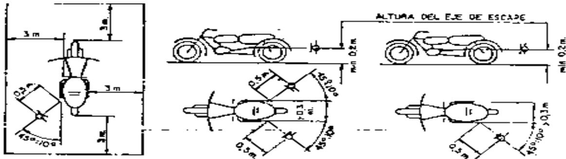
3.3.3.2. Una vez alcanzado el régimen estabilizado, se brava rápidamente el mando de aceleración a la posición de ralentí. El nivel sonoro se mide durante un período de funcionamiento que comprende un breve espacio de tiempo a régimen estabilizado, más toda la duración de la deceleración, considerando como resultado válido de la medida el correspondiente a la indicación máxima del sonómetro.
